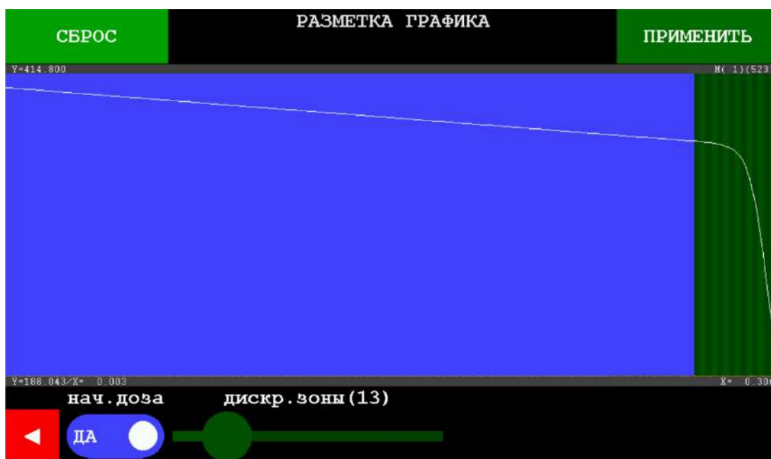
Рисунок 183 - Окно раздела «Разметка графика» с кривой пробного титрования, полученной методом «Кондуктометрический мкСм» способом «Регистрация кривой», с оптимизированным положением границы цветных секторов и отрегулированной дискретностью подачи титранта
