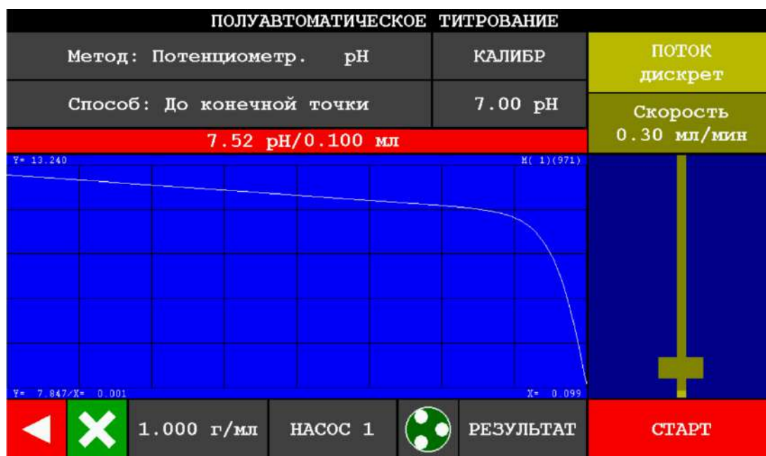
Рисунок 121 – Внешний вид окна раздела «Титрование полуавтоматическое» в ходе титрования способом «До конечной точки» по истечении отсчета выдержки, когда требуется дотитровка (конечная точка титрования не достигнута)
