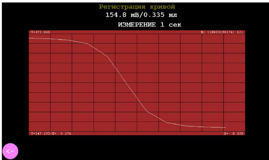
Рисунок 185 – Пример отображаемой на дисплее информации в ходе выполнения титрования по сохраненной методике
