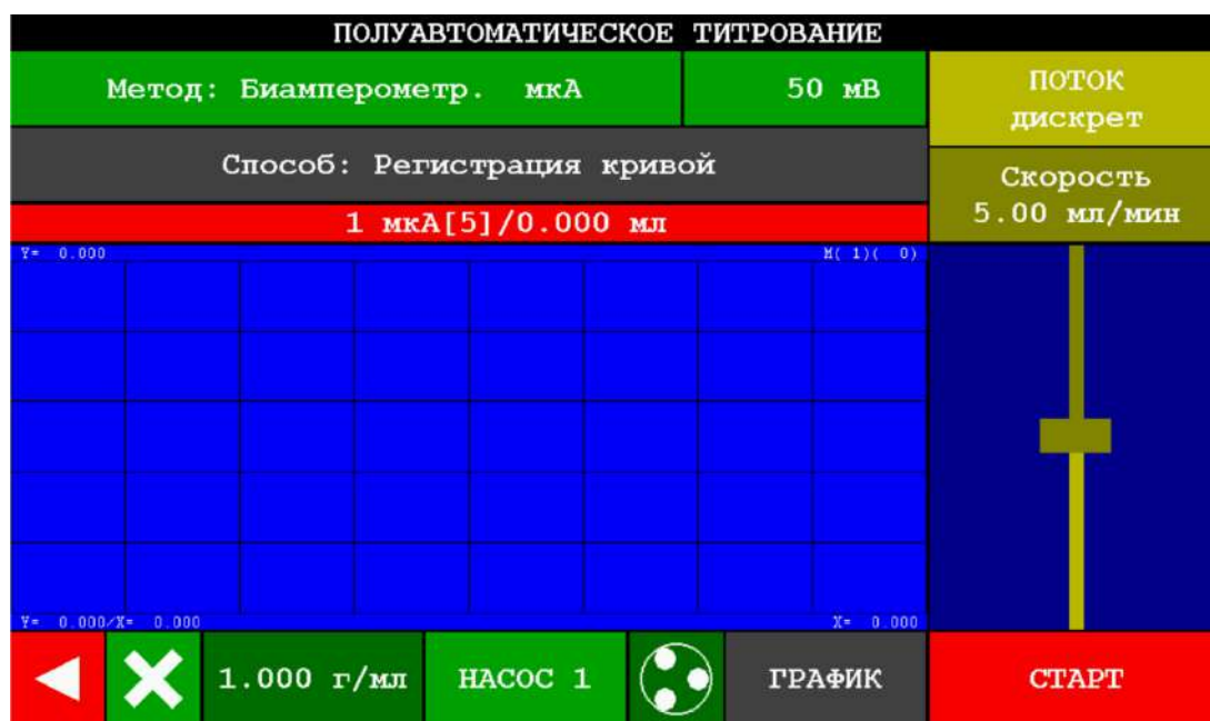
Рисунок 84 – Окно раздела «Титрование полуавтоматическое» после сохранения нового значения напряжения, подаваемого на ПИП
