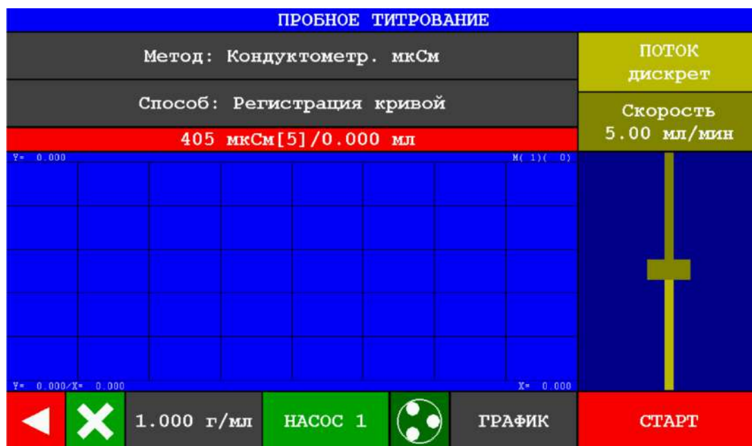
Рисунок 178 – Окно раздела «Пробное титрование» для метода «Кондуктометрический мкСм» и способа «Регистрация кривой»
