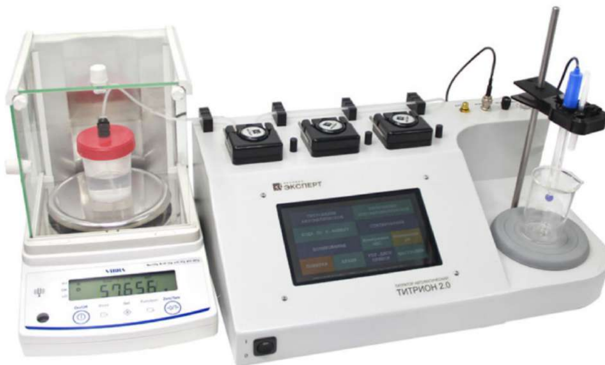
Рисунок 14 – Внешний вид титратора в собранном виде на примере комплектации с одной ёмкостью для титранта, одной гибкой трубкой и ПИП для кислотно-основного потенциометрического титрования
