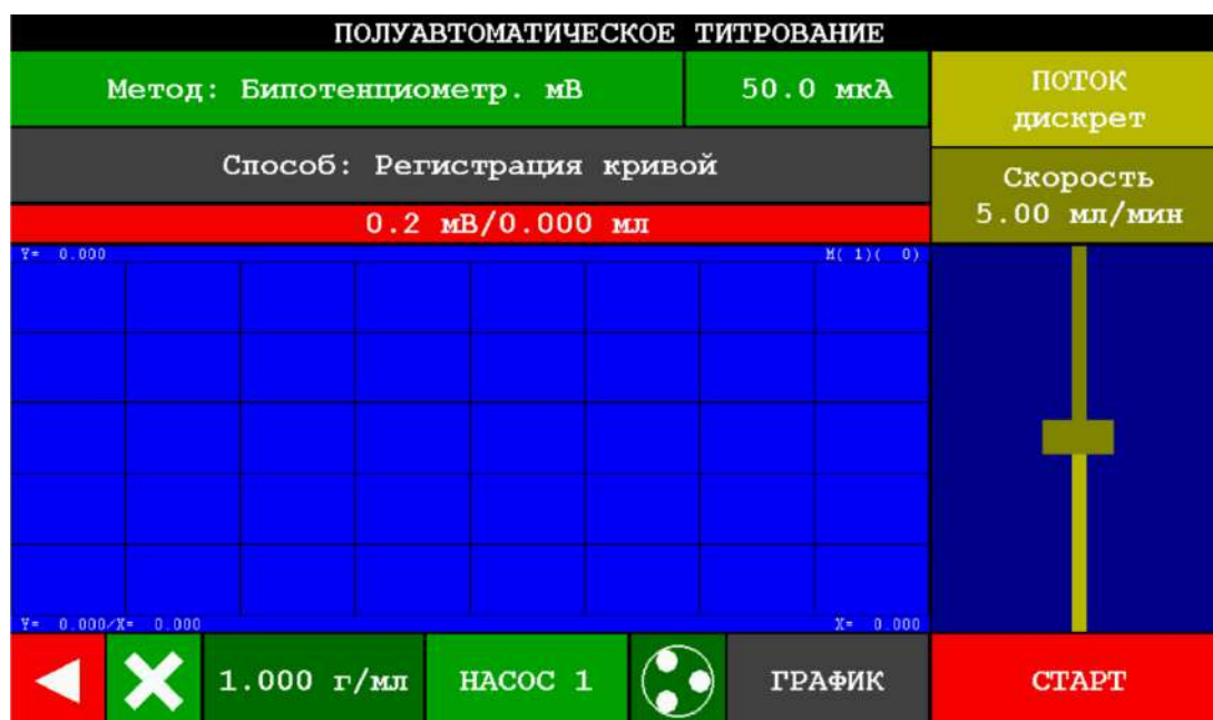
Рисунок 80 – Окно раздела «Титрование полуавтоматическое» после сохранения нового значения силы тока, пропускаемого через ПИП
