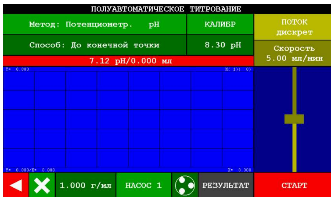
Рисунок 88 – Окно раздела «Титрование полуавтоматическое» после сохранения нового значения КТТ для метода титрования «Потенциометрический pH» и способа титрования «До конечной точки»
