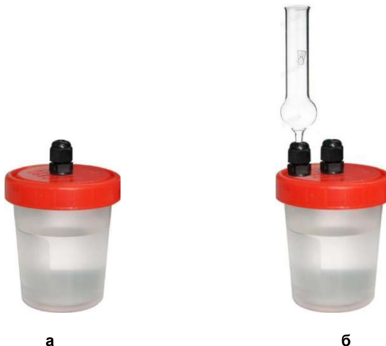
Рисунок 6 – Внешний вид ёмкостей для титранта или вспомогательного раствора с крышкой с микроотверстием (а) и с крышкой с гермовводом для установки хлоркальциевой трубкой;
