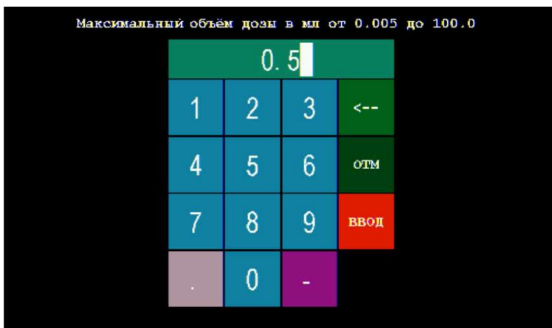
Рисунок 102 – Окно для ввода значения максимального объёма дозы титранта с набранным значением «0.5»
