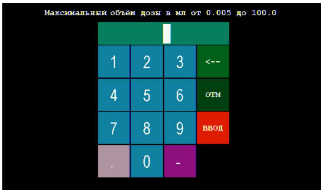
Рисунок 101 – Окно для ввода значения максимального объёма дозы титранта
