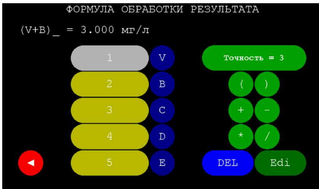
Рисунок 159 – Редактор формул обработки результатов титрования
