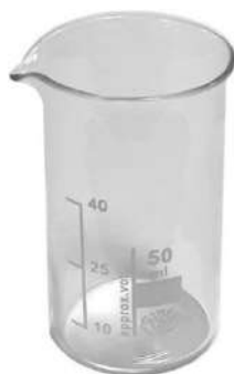
Рисунок 8 – Внешний вид ёмкости для титруемого раствора, применяемого в режиме фотометрического титрования/статирования
