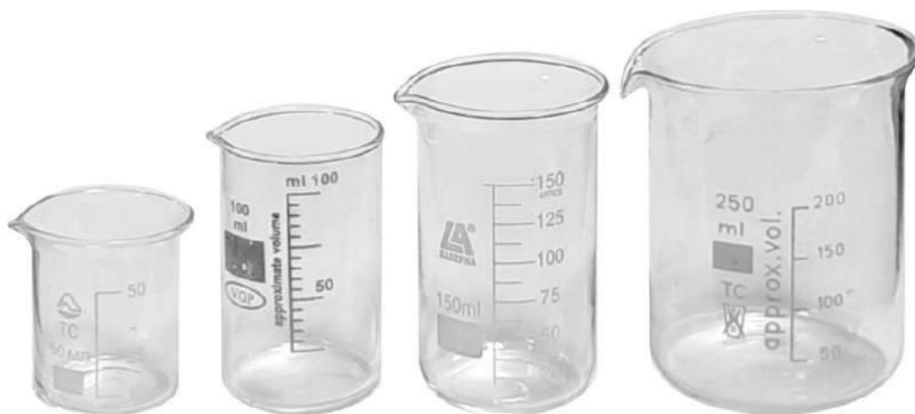
Рисунок 7 – Внешний вид ёмкостей для титруемого (анализируемого) раствора, применяемых в режимах измерения pH, ЭДС (Eh), потенциометрического кислотно-основного и окислительно-восстановительного титрования/статирования, потенциометрического осадительного титрования, кондуктометрического титрования/статирования и амперометрического титрования
