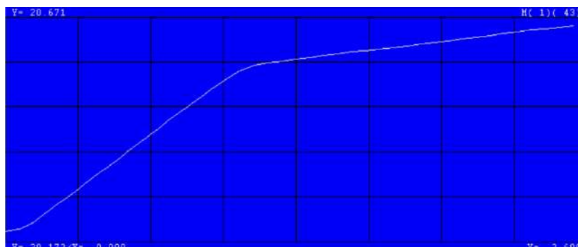
Рисунок 118 – Пример кривой титрования с участком в виде излома линии
