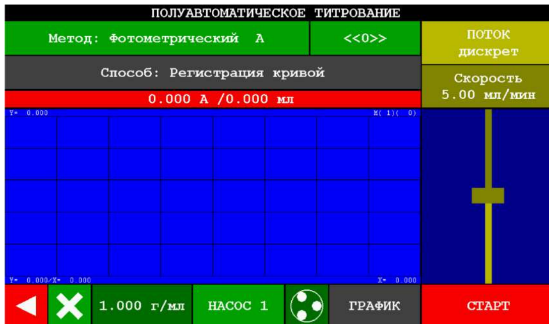
Рисунок 76 – Окно раздела «Титрование полуавтоматическое» с установленным методом титрования «Фотометрический А» после зануления показаний ПИП по холостой пробе
