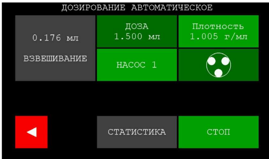
Рисунок 70 – Окно раздела «Дозирование автоматическое» в момент остановки дозирования для взвешивания ёмкости с дозируемым раствором
