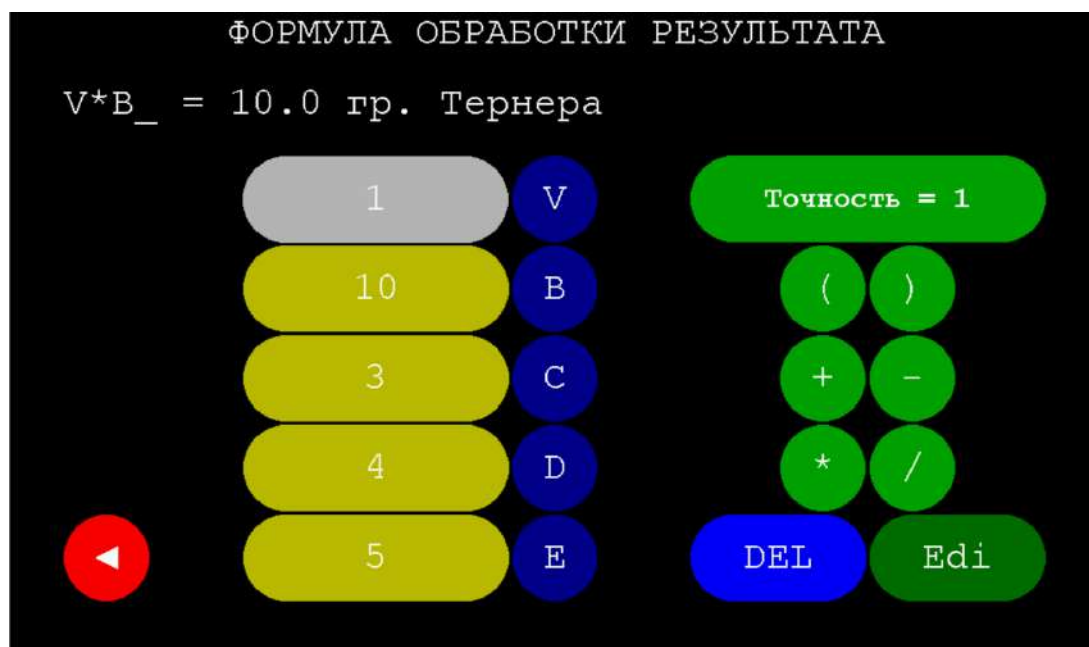
Рисунок 160 – Редактор формул обработки результатов титрования с формулой для расчета кислотности молока по ГОСТ Р 54669
