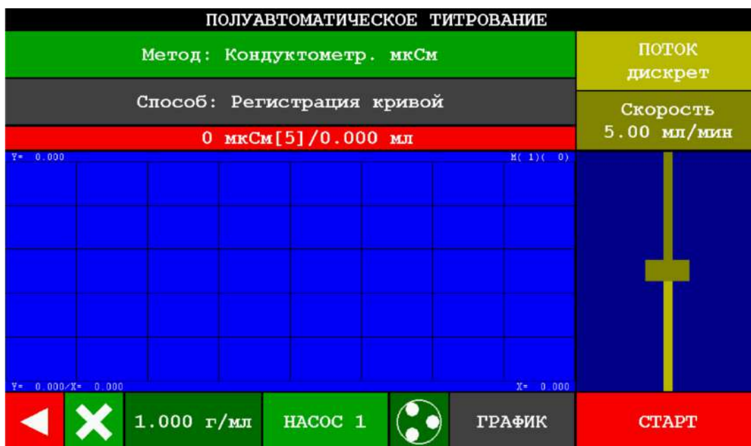
Рисунок 74 – Окно раздела «Титрование полуавтоматическое» с установленным методом титрования «Кондуктометрический мкСм»
