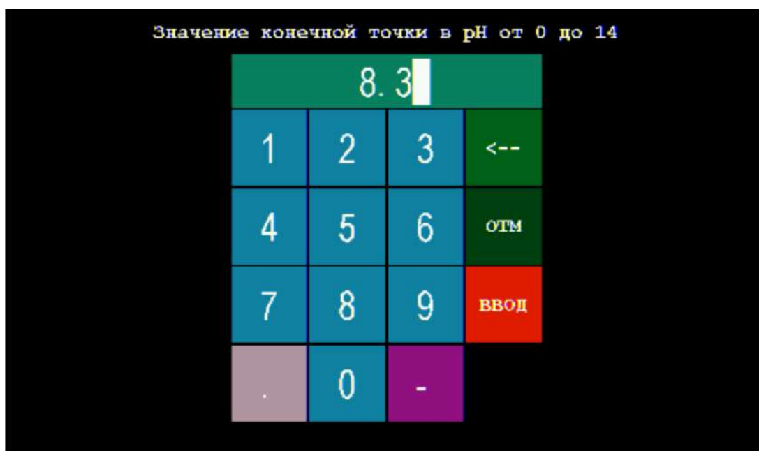
Рисунок 86 – Окно для ввода значения конечной точки титрования с набранным значением «8.3»
