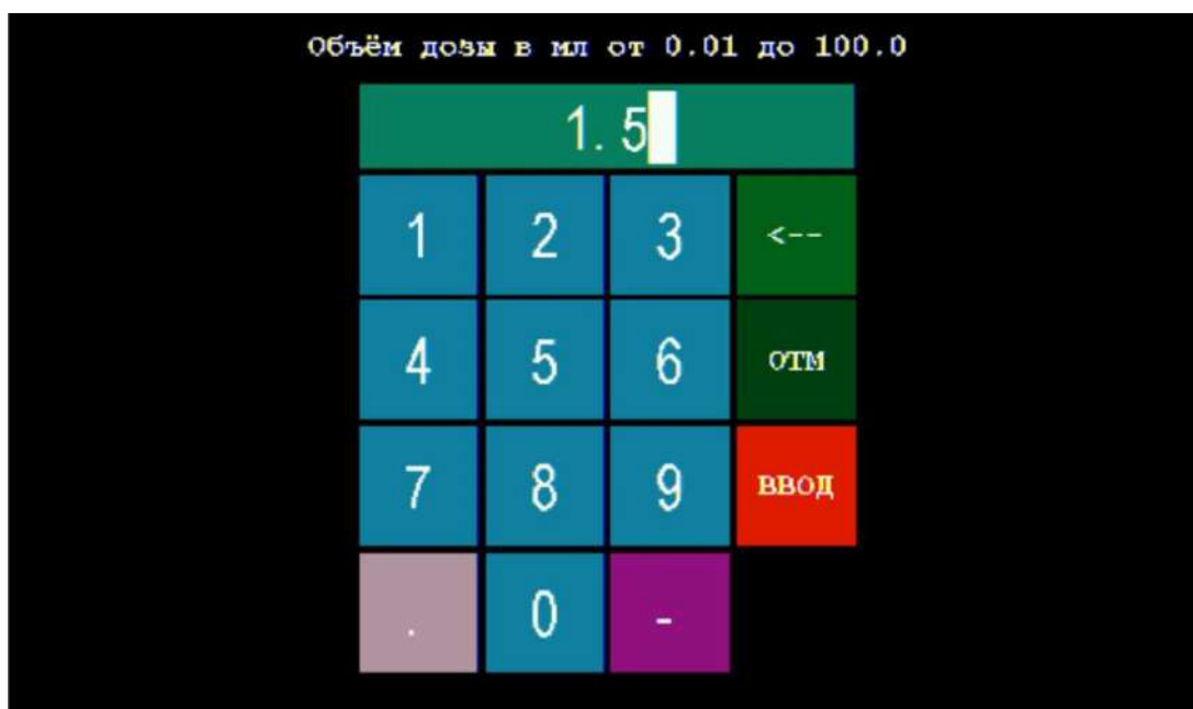
Рисунок 63 – Окно для ввода значения объёма дозы с набранным значением «1.5»
