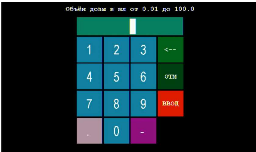
Рисунок 62 – Окно для ввода значения объёма дозы
