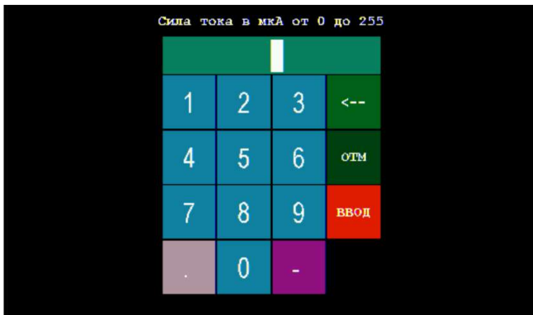
Рисунок 77 – Окно для ввода значения силы тока, пропускаемого через ПИП при титровании по методу «Бипотенциометрический мВ»
