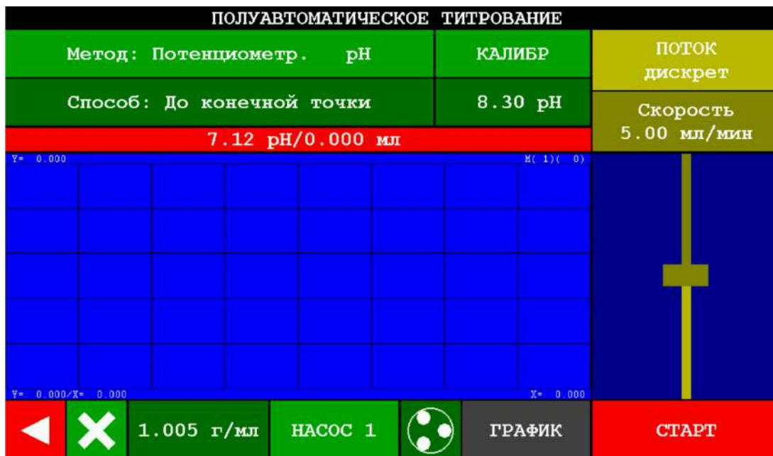
Рисунок 89 – Окно раздела «Титрование полуавтоматическое» после сохранения нового значения плотности для насоса 1
