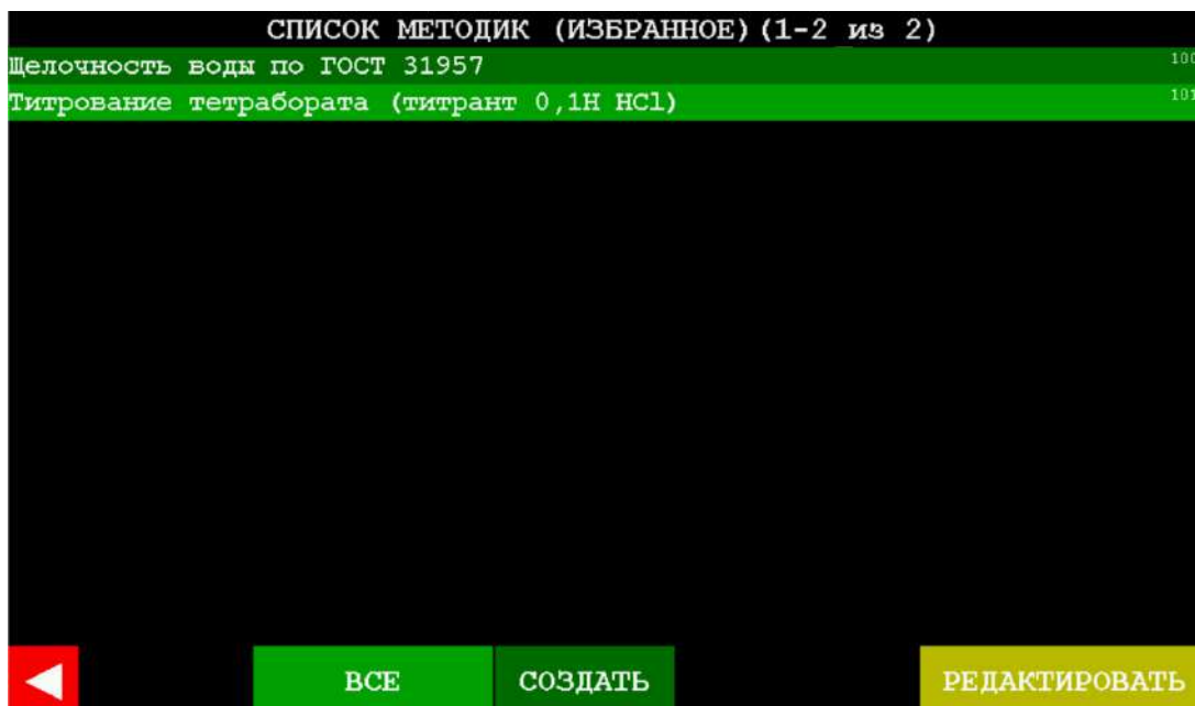
Рисунок 153 – Окно раздела «Титрование автоматическое» с отредактированным списком избранных методик
