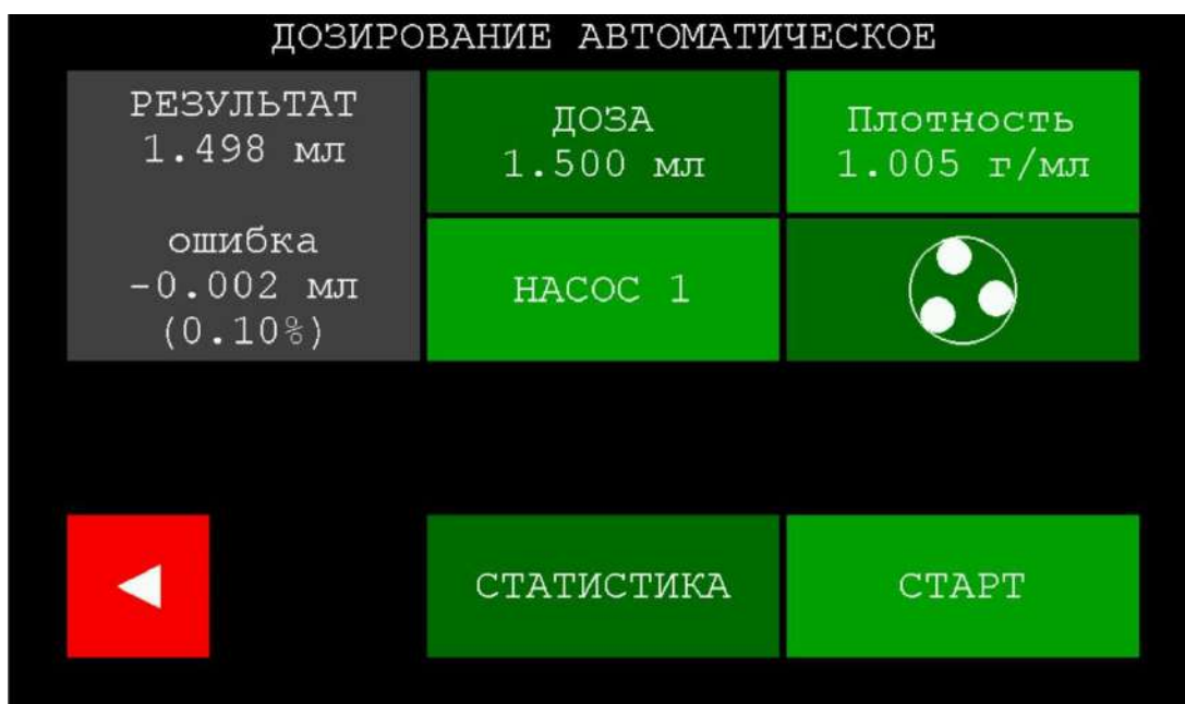
Рисунок 71 – Окно раздела «Дозирование автоматическое» после завершения дозирования
