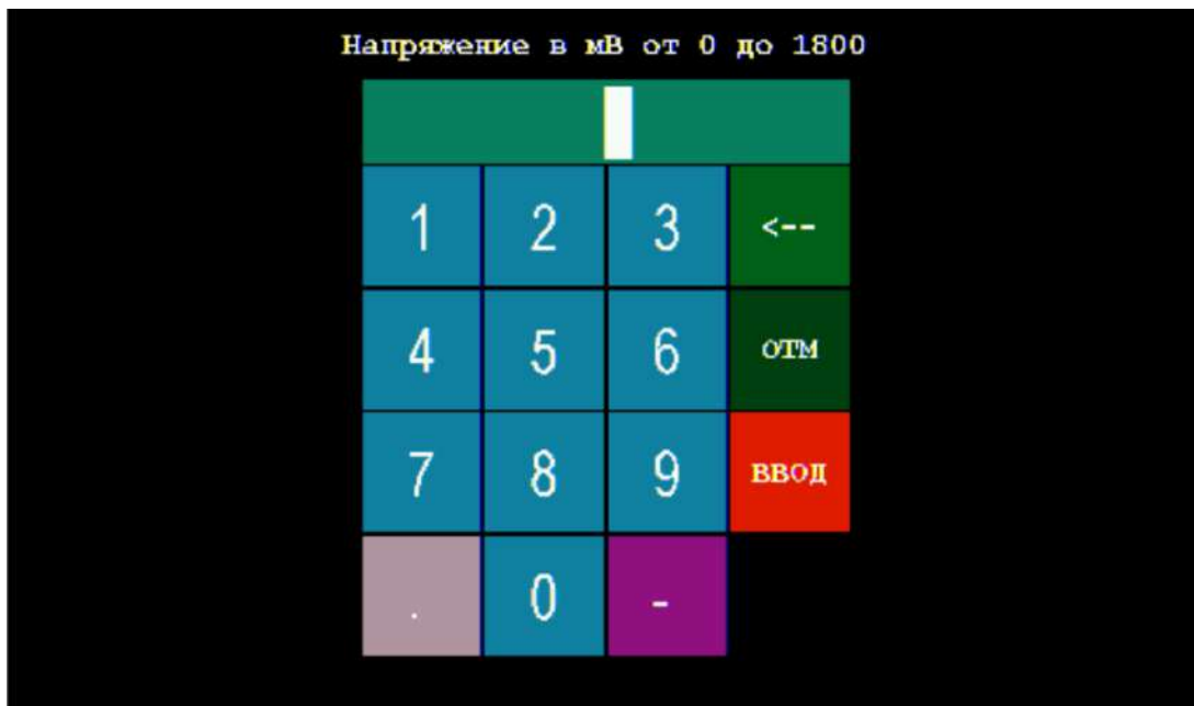
Рисунок 81 – Окно для ввода значения напряжения, подаваемого на ПИП при титровании по методу «Биамперометрический мкА»
