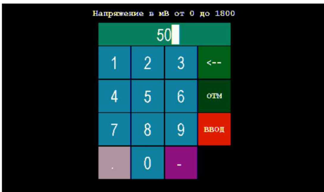
Рисунок 82 – Окно для ввода значения напряжения с набранным значением «50»
