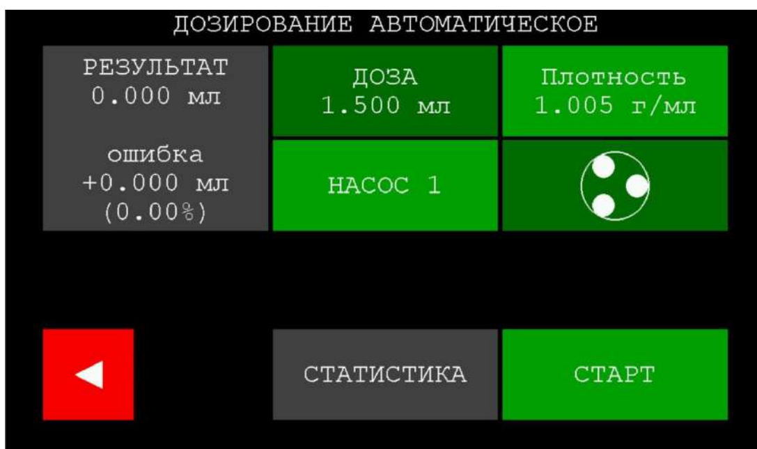
Рисунок 69 – Окно раздела «Дозирование автоматическое» после сохранения нового значения плотности для насоса 1
