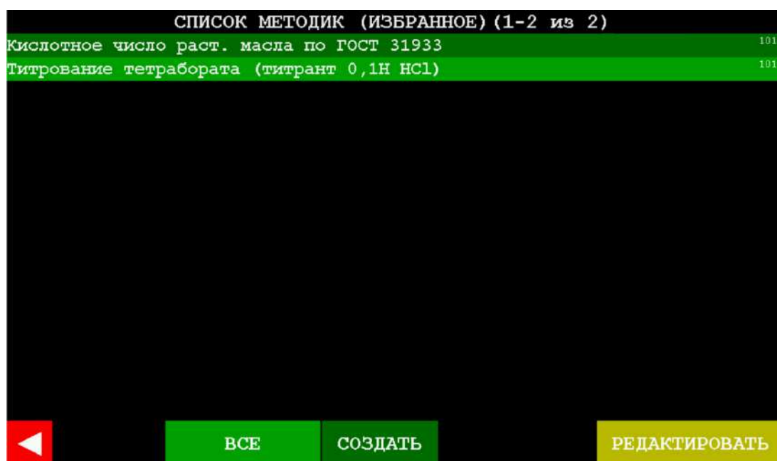
Рисунок 150 – Окно раздела «Титрование автоматическое» со списком избранных методик
