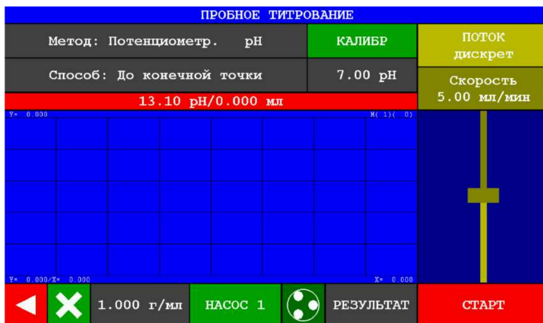
Рисунок 172 – Окно раздела «Пробное титрование» для метода «Потенциометрический рН» и способа «До конечной точки»
