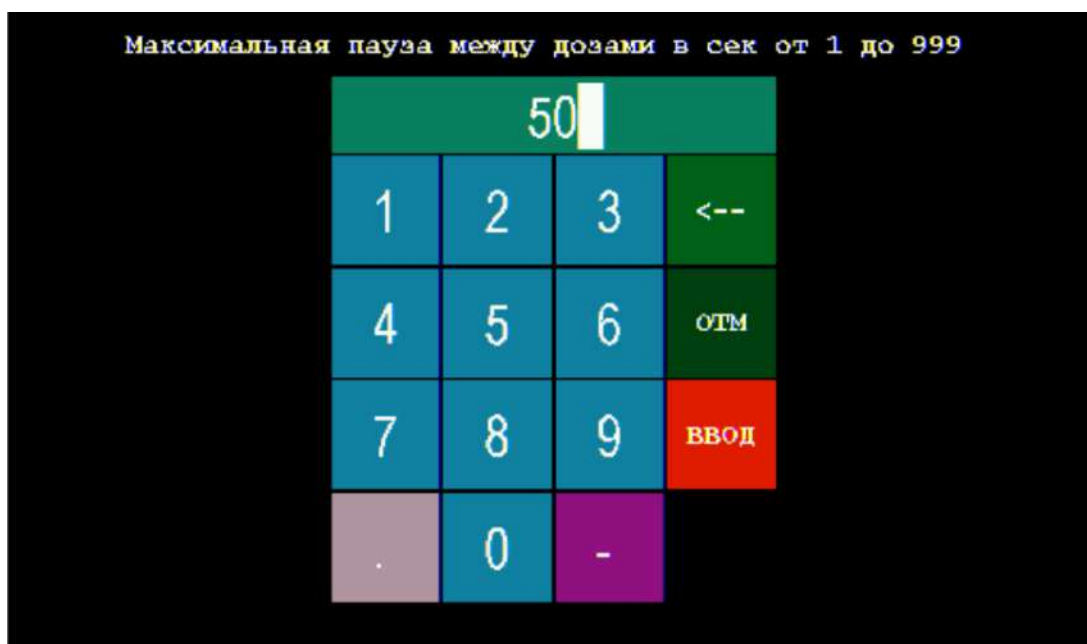
Рисунок 112 – Окно для ввода значения максимальной продолжительности паузы между дозами титранта с набранным значением «50»
